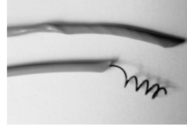
Figura 2. Fotografía del conjunto catéter-resorte utilizados en la prueba in vivo, en la parte superior el resorte se halla contenido por el catéter (fase martensítica), en la parte inferior se observa el resorte emergiendo del catéter (fase austenítica).
