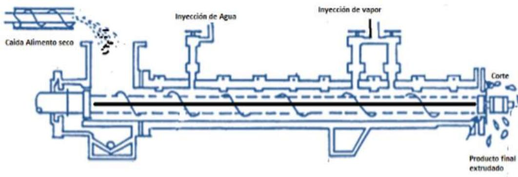
**FIGURA 11.** Equipo de extrusión.
