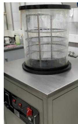
Figura 2 Liofilizador utilizado
