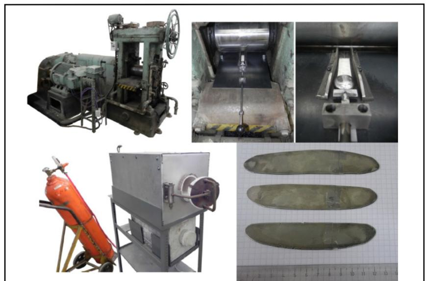
**Figura 7:** Aquí puede verse la laminadora, con detalle del rodillo y el dispositivo para impulsar las muestras hacia los rodillos (arriba), y el horno y el aspecto de las muestras luego del proceso termomecánico, en la parte de abajo.
