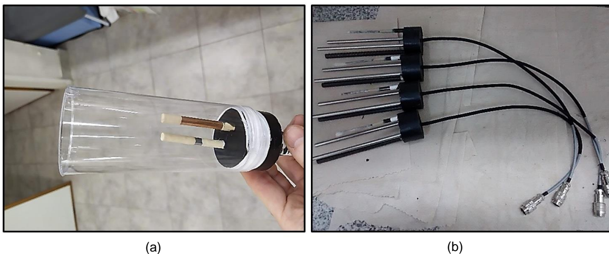
Figura 7. Adaptaciones de sensores. (a) Adaptación para ejecutar nuevas técnicas electroquímicas. (b) Adaptación para utilización en hormigones especiales.
