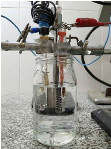
Figura 2: Disposición de electrodos en la solución para el ensayo PCA.
