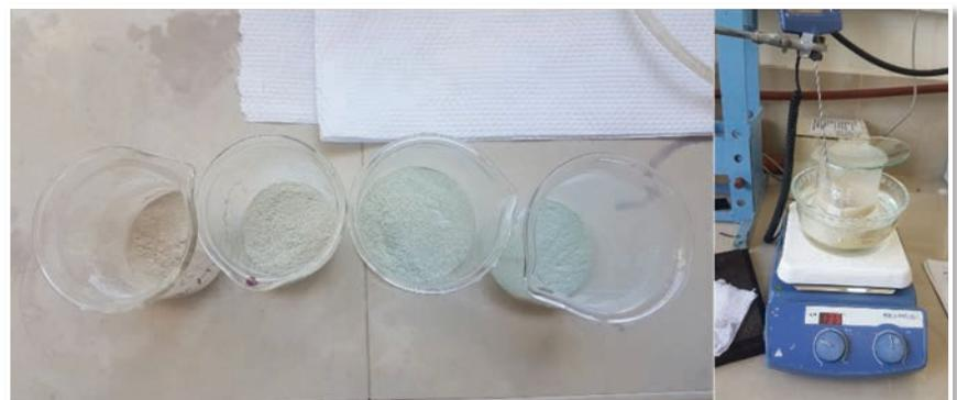
Figura 3: Izquierda: arcillas modificadas en laboratorio con una sal cuaternaria de amonio. Derecha: etapa de intercambio catiónico con el surfactante.
