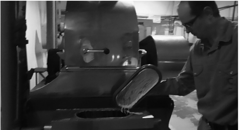
Figura 9 — Chips transformados en pasta mediante el equipo desintegrador.
