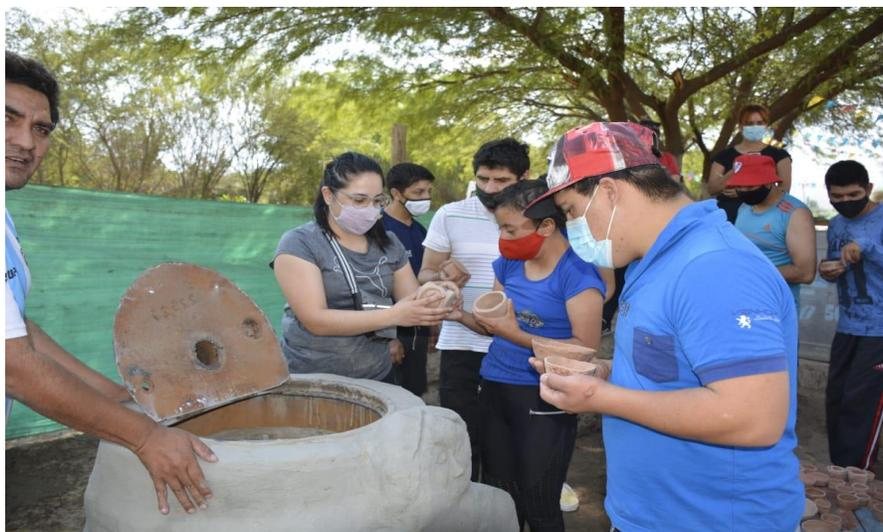
Figura 10. Colocación de las piezas elaboradas en el interior del horno
