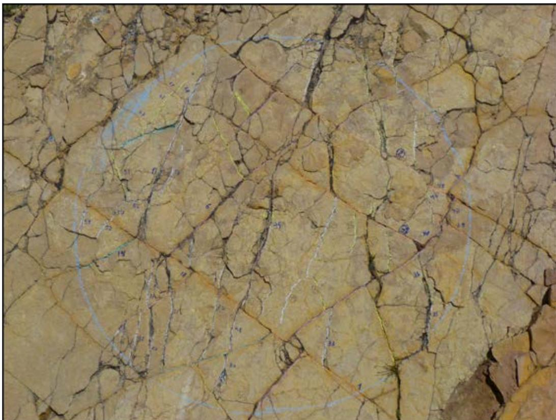
**Figura 1.** *Scanline* circular de 2 m de diámetro realizado sobre un afloramiento (techo) de la Formación Yacoraite.
