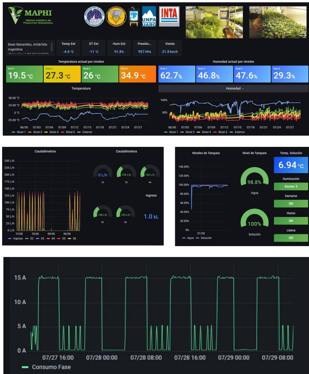
**Figura 4.** Captura de pantalla del panel de control y monitoreo que se genera a partir de la tecnología IoT instalada. Se observan distintos parámetros como la temperatura del aire exterior, interior, humedad relativa, estado general del cultivo (mediante cámaras de alta definición), nivel de los tanques de agua y solución nutritiva, estado Ok de los sensores de iluminación, derrame, humo y llama, y por debajo el consumo eléctrico histórico del módulo en su conjunto.
