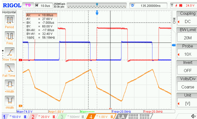
Fig. 15. Formas de onda implementación del DAB. CH1 (color azul): tensión v_{DS\_Q3\_A} del puente P_1 . CH2 (color rojo): tensión v_{DS\_Q3\_A} del puente P_2 . CH4 (color naranja): corriente i_L sensor LEM.
