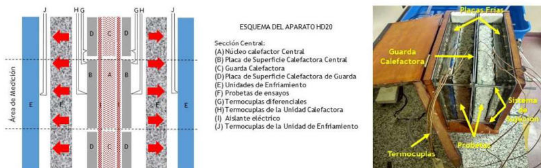
Figura 4: Esquema del aparato HD20.
