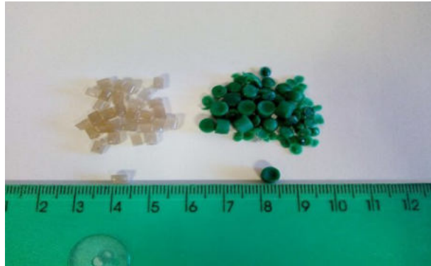
Figura 2: A la izquierda el PEBD y ala derecha de color verde el PEAD.
