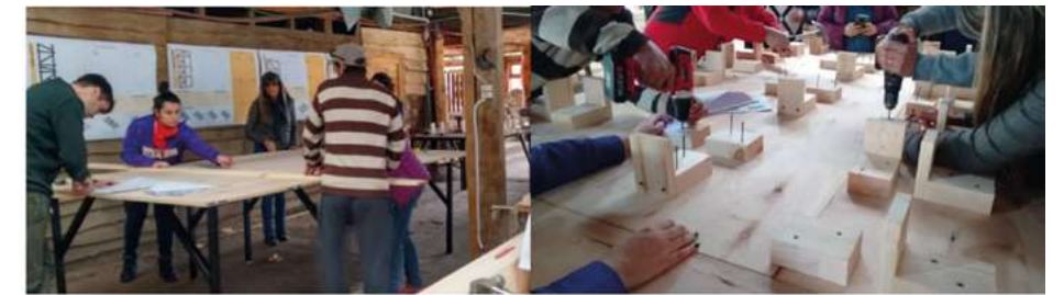
Fig. 3 y 4: Manos a la obra. Construcción de las matrices que servirán a modo de plantilla para el armado de componentes prefabricados en madera: cabriadas, paneles verticales, complementos y paneles de techo. Fuente: Archivo fotográfico del programa Co-construcción del Conocimiento.
