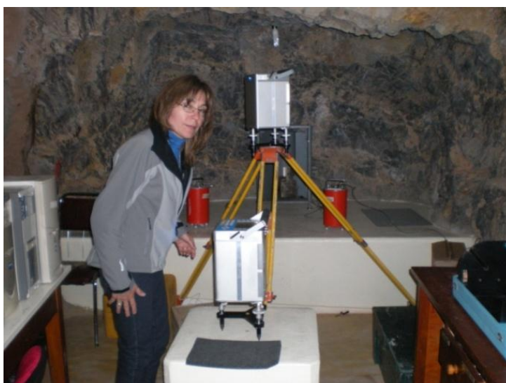
Figura 13: Medición del gradiente vertical de gravedad en el sitio de gravedad absoluta ubicado en el Instituto Geofísico Sismológico Fernando Volponi (Universidad Nacional de San Juan).
