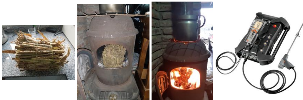
Fig. : Fardos de AD caracterizados previos a la combustión, equipamiento utilizado e instrumental para la medición de los gases de combustión
