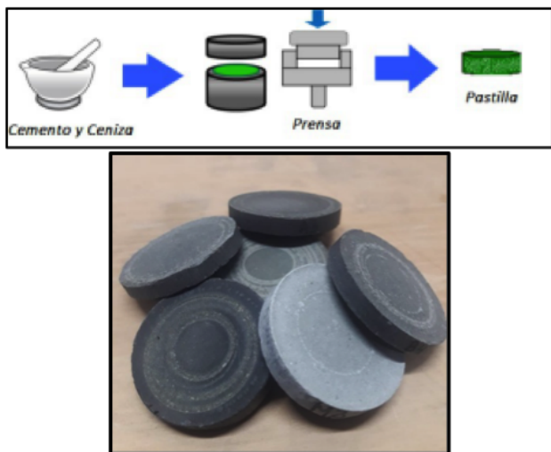
FIG. 1: (a) Esquema de preparación de muestras. (b) Pastillas de Cemento Portland a distintas concentraciones de ceniza.
