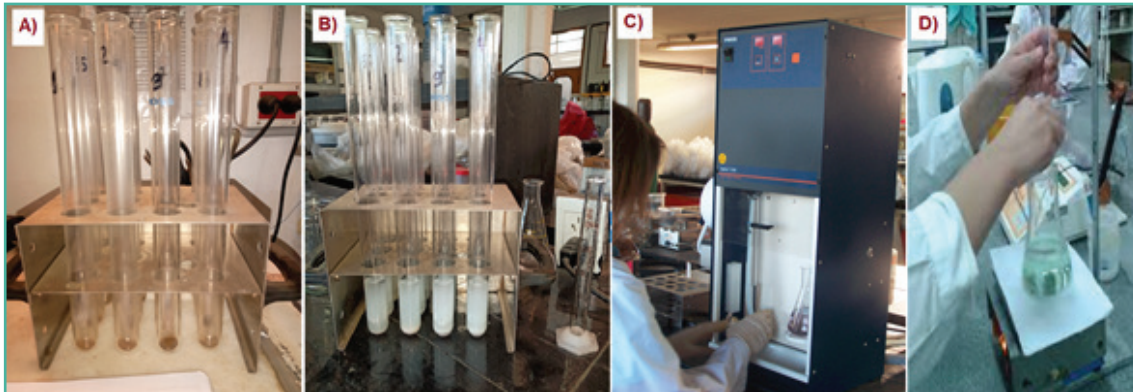
Figura 2: Etapas del análisis de N por método Kjeldahl del laboratorio de Suelos y Aguas EEA Bariloche: A) pesada de suelos, B) tubos luego de proceso de digestión, C) equipo Kjeldahl en acción, D) titulación del N con medio ácido e indicador.
