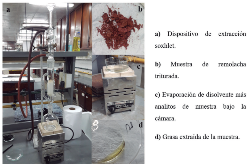
Fig. 8. Método de Soxhlet para extracción de lípidos
