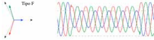
Figura 9. Hueco de tensión trifásico q = F .
