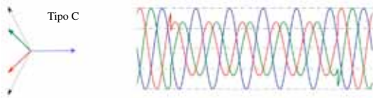
Figura 6. Hueco de tensión trifásico q=C .
