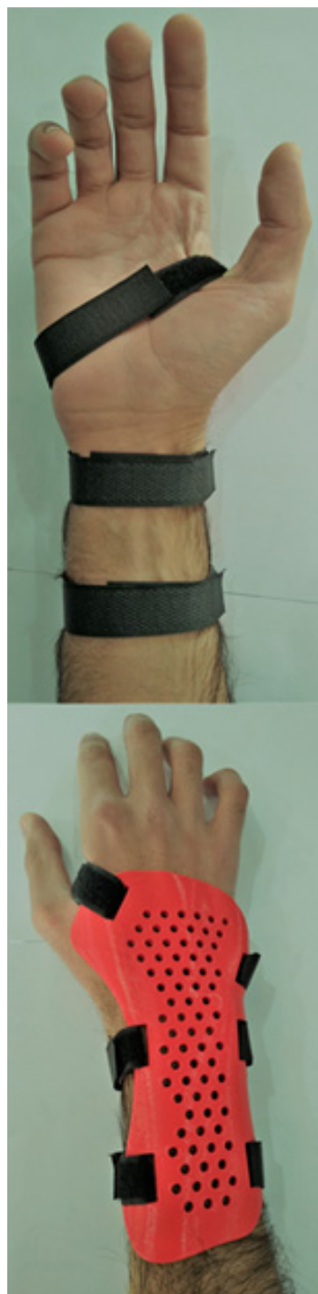
Figura 10. Calce del prototipo en un antebrazo de prueba.
