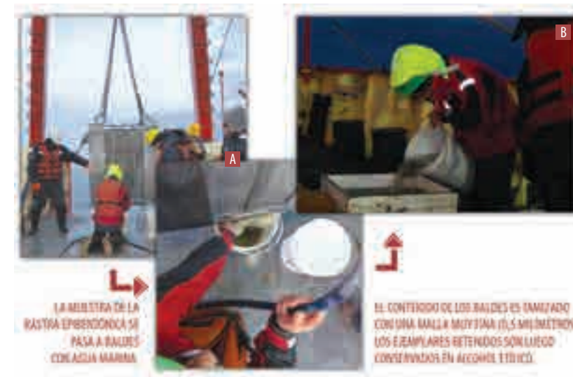
Figura 3. Cuando la rastra epibentónica (A) llega a la cubierta, se recoge su contenido en baldes e inmediatamente después se recuperan los ejemplares tamizando la muestra (B). Su contenido se almacena en frascos más chicos que llegan al laboratorio.
