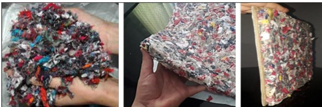
Figura 1: Placa de aislación térmica AISLA-SUSTEX ejecutada con residuos textil. Fuente: Elaboración propia.
