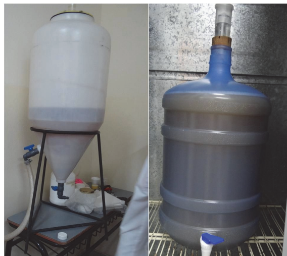
Figura 3. Fermentadores disponibles en la planta piloto. A la izquierda, el fermentador de 60 L y a la derecha el fermentador de 20 L. Fuente: Los autores.
