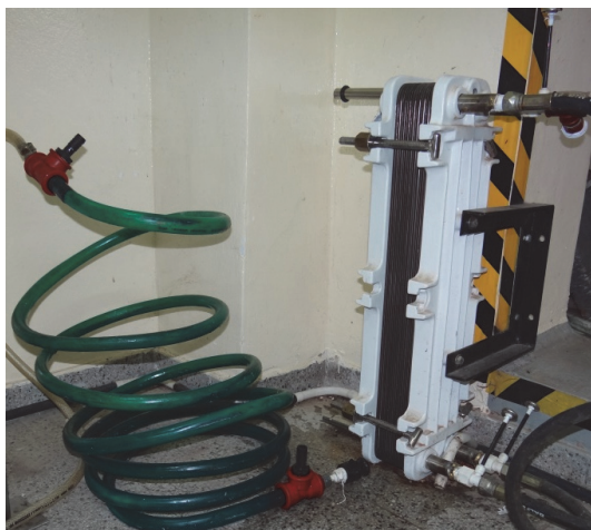
Figura 2. Equipos disponibles para el enfriamiento del mosto. A la izquierda, el intercambiador tubular y a la derecha, el intercambiador de placas. Fuente: Los autores.
