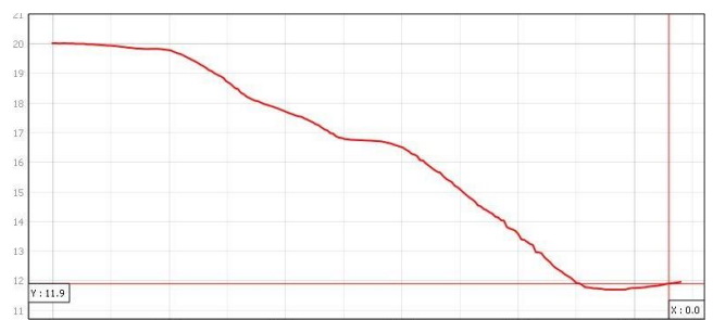
Fig. 17: Perfil transversal del talud EG 17, previo al derrumbe.
