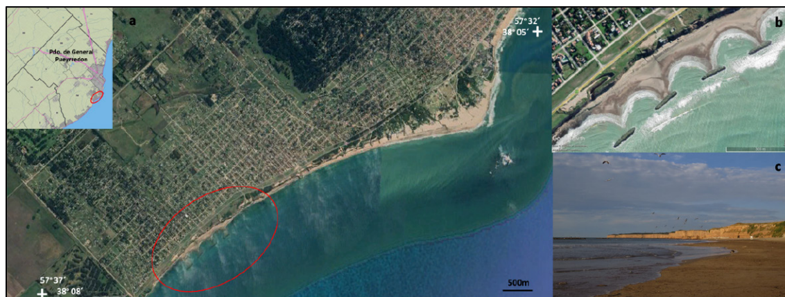
Figura 4. Obra de defensa costera y generación de playas. A) Ubicación. B) Vista de espigones en 2020. C) Playa recuperada. Fuente: Google Earth mayo 2020 y Juan L. Farina 21/01/2018.
