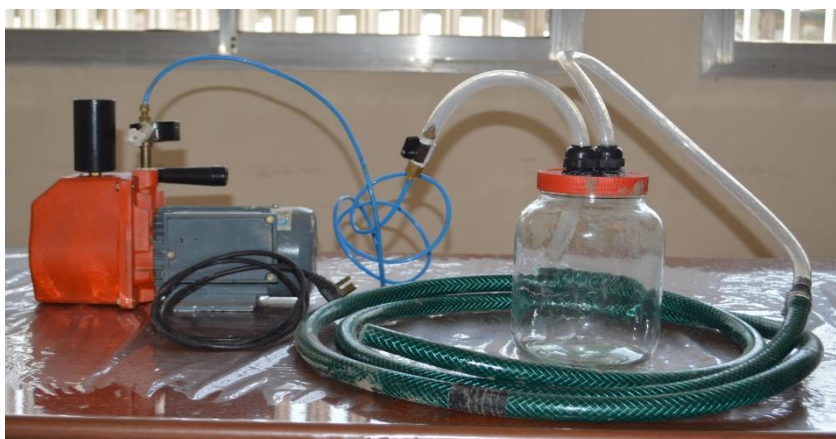
Ilustración 2. Bomba y sistema de vacío propuesto.
