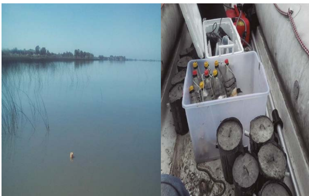
Figura 2. Colocación de sensores para el registro de la temperatura del agua.
