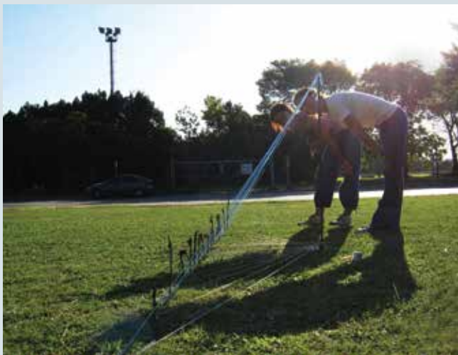
Figura 4 (izquierda). Los hilos que unen el extremo del gnomon con cada uno de los puntos que indican la sombra de ese extremo en diferentes horas del día determinan un plano materializado por hilos azules. El ángulo entre el gnomon y ese plano es la latitud del lugar, en este caso, unos 35^\circ , correspondientes a Buenos Aires. El norte está hacia la derecha de la foto y el polo sur celeste en la dirección marcada por una perpendicular al mencionado plano, hacia arriba y a la izquierda. Figura 5 (derecha). Estudiantes trabajando en la Ciudad Universitaria de la UBA, en Núñez. La actividad completa llevó varias horas al Sol, durante el viernes 20 de marzo de 2009, día del equinoccio de otoño en el hemisferio sur. El predio arbolado de la imagen, sitio de descanso y punto de reunión para centenares de estudiantes, muy pronto cederá su lugar al cemento y a los vidrios del edificio Cero + Infinito.
