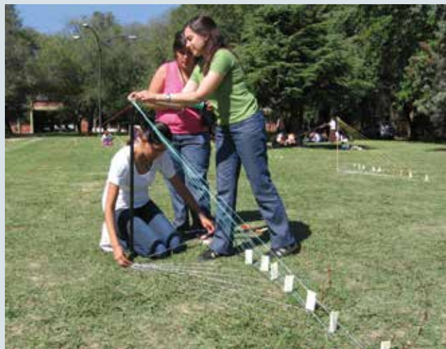
Figura 4 (izquierda). Los hilos que unen el extremo del gnomon con cada uno de los puntos que indican la sombra de ese extremo en diferentes horas del día determinan un plano materializado por hilos azules. El ángulo entre el gnomon y ese plano es la latitud del lugar, en este caso, unos 35^\circ , correspondientes a Buenos Aires. El norte está hacia la derecha de la foto y el polo sur celeste en la dirección marcada por una perpendicular al mencionado plano, hacia arriba y a la izquierda. Figura 5 (derecha). Estudiantes trabajando en la Ciudad Universitaria de la UBA, en Núñez. La actividad completa llevó varias horas al Sol, durante el viernes 20 de marzo de 2009, día del equinoccio de otoño en el hemisferio sur. El predio arbolado de la imagen, sitio de descanso y punto de reunión para centenares de estudiantes, muy pronto cederá su lugar al cemento y a los vidrios del edificio Cero + Infinito.
