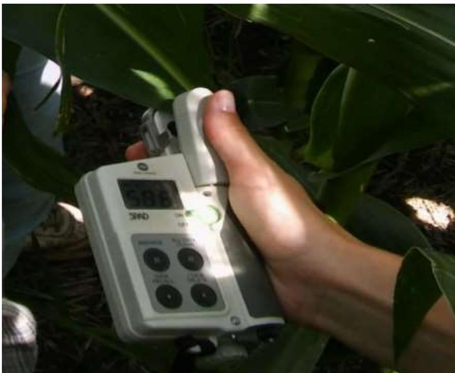
**Fig. 4.** Equipo clorofilómetro SPAD-502™ utilizado para medir la funcionalidad del aparato fotosintético y perfil de senescencia foliar en esta experiencia.
