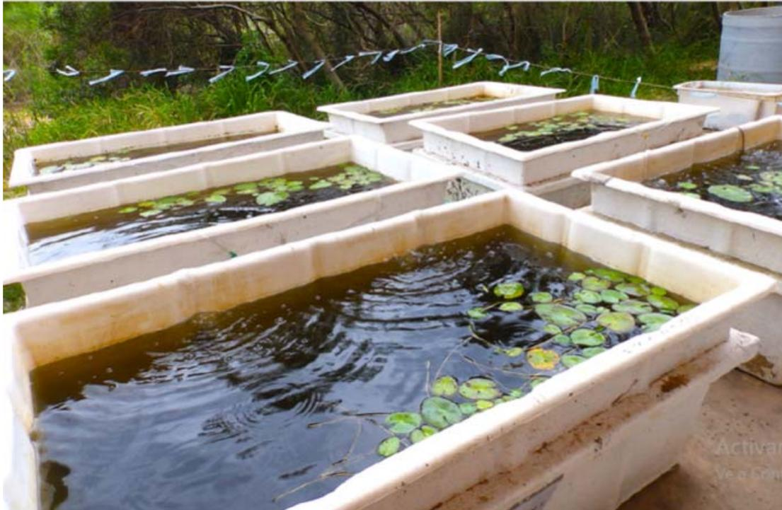
Figura 11.5: Mesocosmos de 600 L empleados para evaluar los efectos de dos concentraciones de glifosato sobre el plancton (fito y zooplancton).
