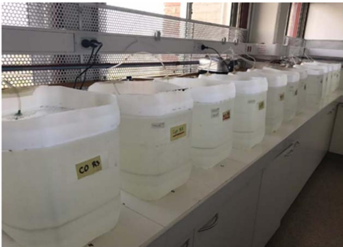
Figura 11.9: Mesocosmos de 30 L para evaluar los efectos de glifosato y cipermetrina aislados y en mezcla sobre el plancton.
