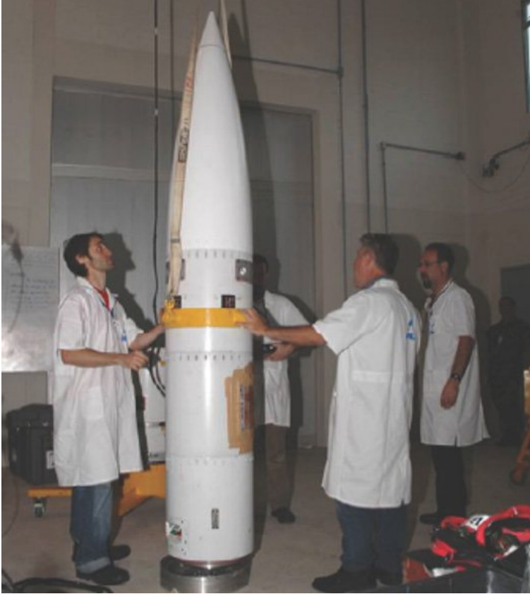
Figura 7. Cofia del cohete VS-30. Arriba de la faja amarilla se observan dos de los cinco soportes de sensores apareados. Fuente: Departamento Energía Solar, Gerencia Investigación y Aplicaciones, CAC-CNEA.
