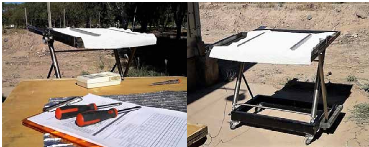
Figura 1: equipo para la determinación de la transmitancia visible.
