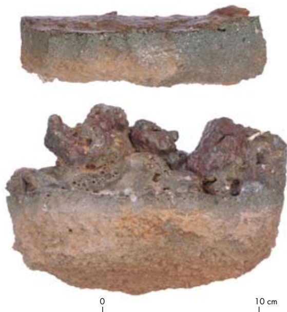
Figura 10. Variedades de escorias metalúrgicas encontradas en la superficie del sector de los hornos. La forma de escoria plana (arriba) ha sido registrada como un subproducto de la fundición de menas de sulfuros de cobre en sitios arqueológicos en Anatolia y Austria fechados para la Edad de Bronce.
