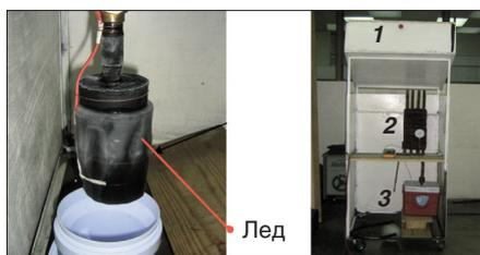
Рис. 2. Прототипы холодильной установки: 1 – коллектор; 2 – конденсатор; 3 – испаритель
