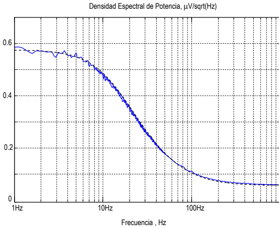
Figura 3. DEP experimental (línea sólida) y teórica (línea punteada) del ruido de MD a la salida de la red.
