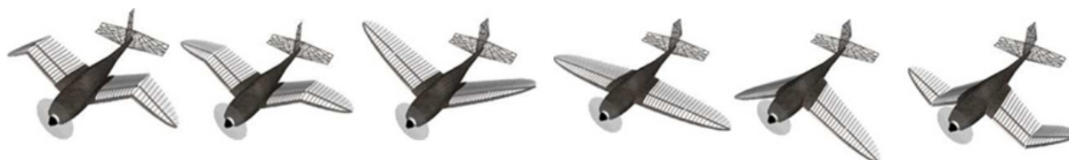
Figura 1: Posiciones típicas de un UAV inspirado en las alas de gaviotas (Abdulrahim y Lind, 2005).
