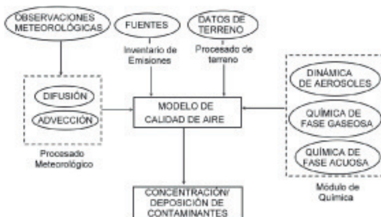
Fig. 1. Principales componentes de un Modelo de Calidad de Aire y sus interacciones
