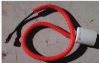
Figura 2. Aspecto final del sensor preparado para ser embebido en una estructura.
