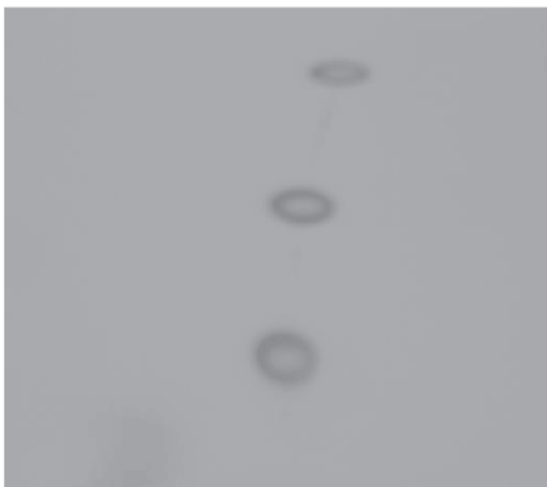
Fig. 14. Eyección producida a través de cuellos múltiples para una solución de 500ppm, f=110\text{H} , a=5,8g .
