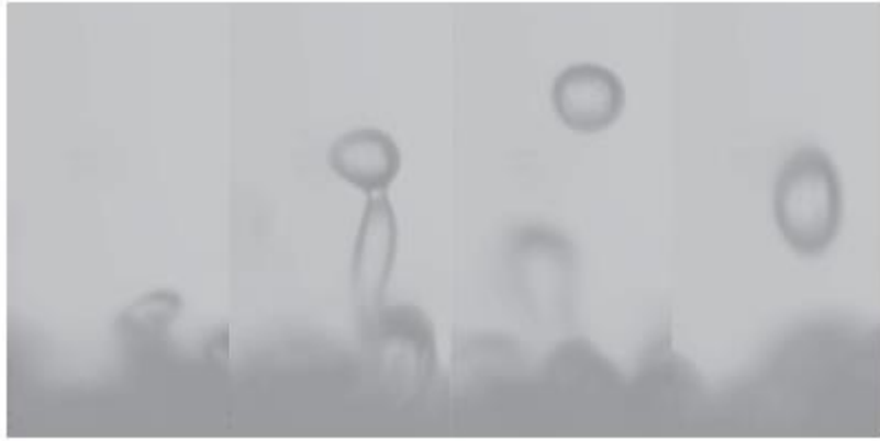
Fig. 11. Eyección de gota desde el pico para POE 250ppm, tiempo entre imágenes 0,025s, f=40\text{Hz} , a=2.6g .
