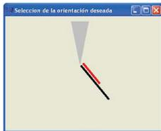
Figura 6. Interfaz visual. La línea roja muestra la magnitud y orientación del *joystick* y la línea negra muestra la magnitud que debe superar la línea roja para seleccionar la orientación deseada. La zona gris marca la zona donde la orientación es cercana a cero.
