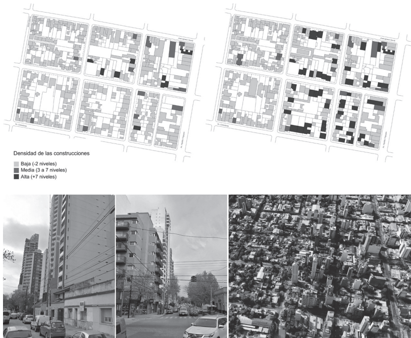
Figura 9. Cambios en la densidad de la edificación: área central (Lomas de Zamora), 2000-2016 (Vecslir, Kozak y Rodríguez, 2016).
