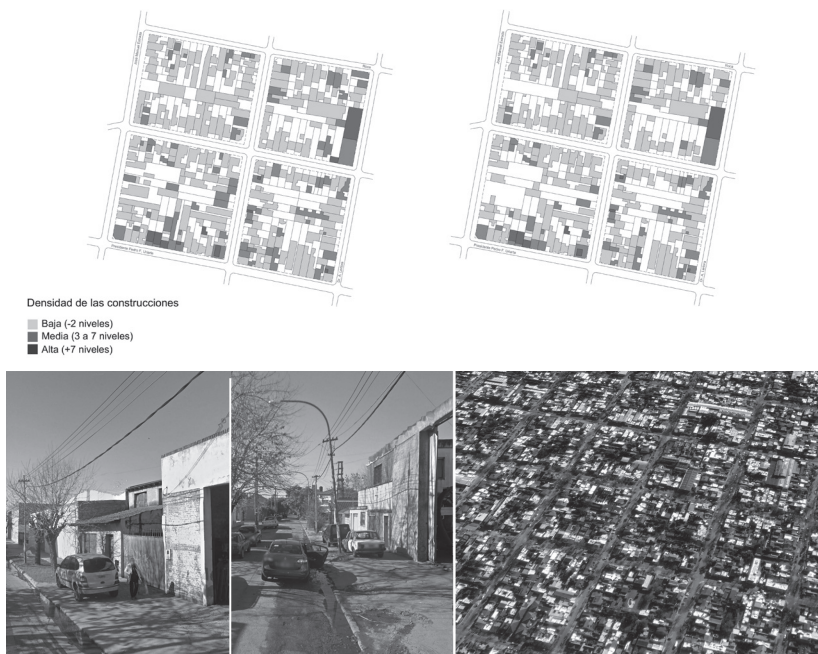
Figura 10. Cambios en la densidad de la edificación: tejido barrial (Lanús), 2000-2016 (Vecslir, Kozak, Rodríguez, 2016).
