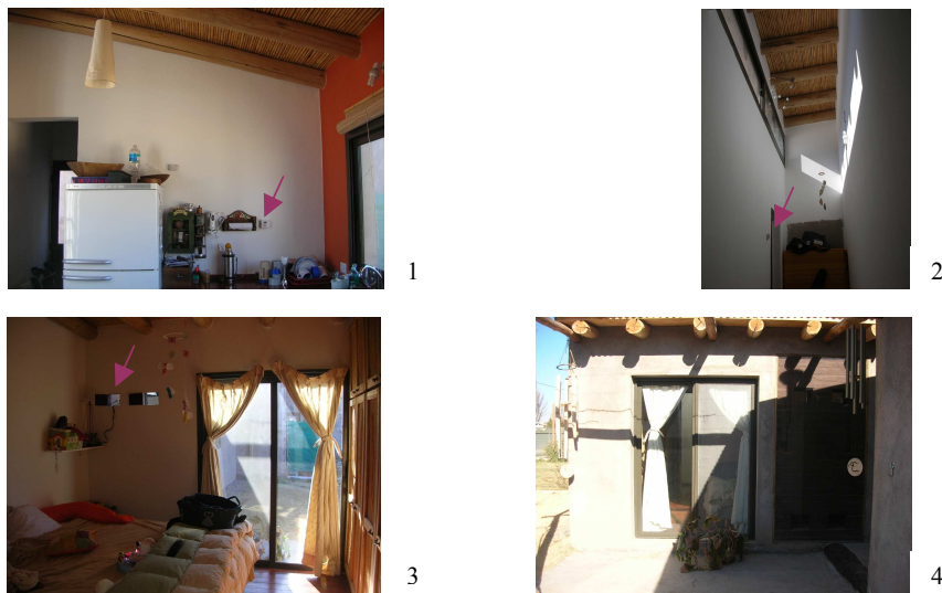
Fig. 8: Fotografías de los ambientes de la vivienda y colocación de sensores, 1- cocina-comedor; 2-paso; 3-dormitorio y muro trombe; 4 exterior de la vivienda
