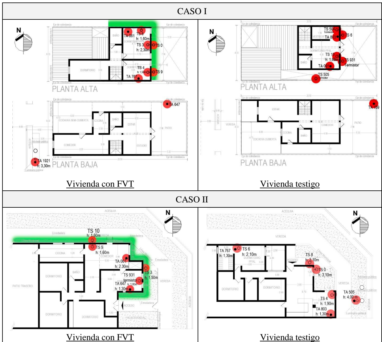
Figura 5 – Plantas de las viviendas evaluadas, ubicación de sensores (color rojo), y ubicación de las FVT (color verde).
