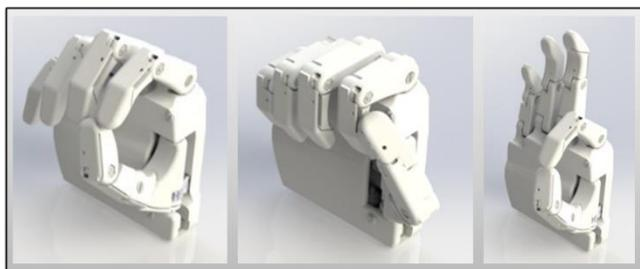
Fig. 3. Configuraciones de agarre diseñadas para el prototipo. Izquierda: configuración tipo cilíndrica. Centro: configuración lateral. Derecha: configuración tipo pinza
