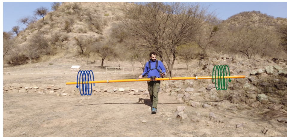
Figura 3. Instrumental utilizado. Se muestra un esquema de la posición de la bobina transmisora (azul) y una bobina receptora (verde) (Fotografía de Santiago Perdomo).
