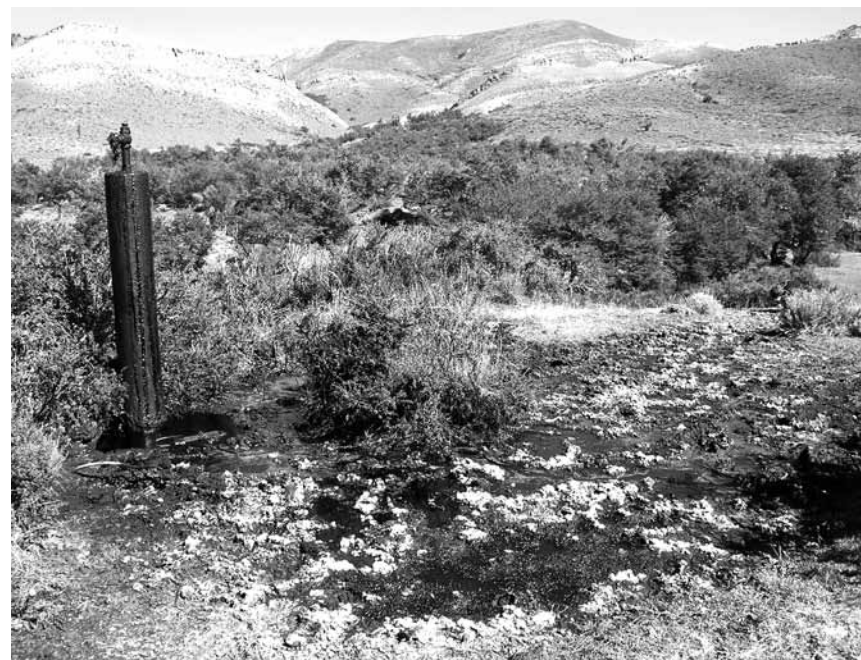
Pozo no remediado vertiendo hidrocarburos en Ñirihuau arriba. Fuente: OPSur.
