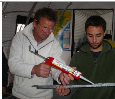
Figura 7. Sellado del policarbonato de la caja.
