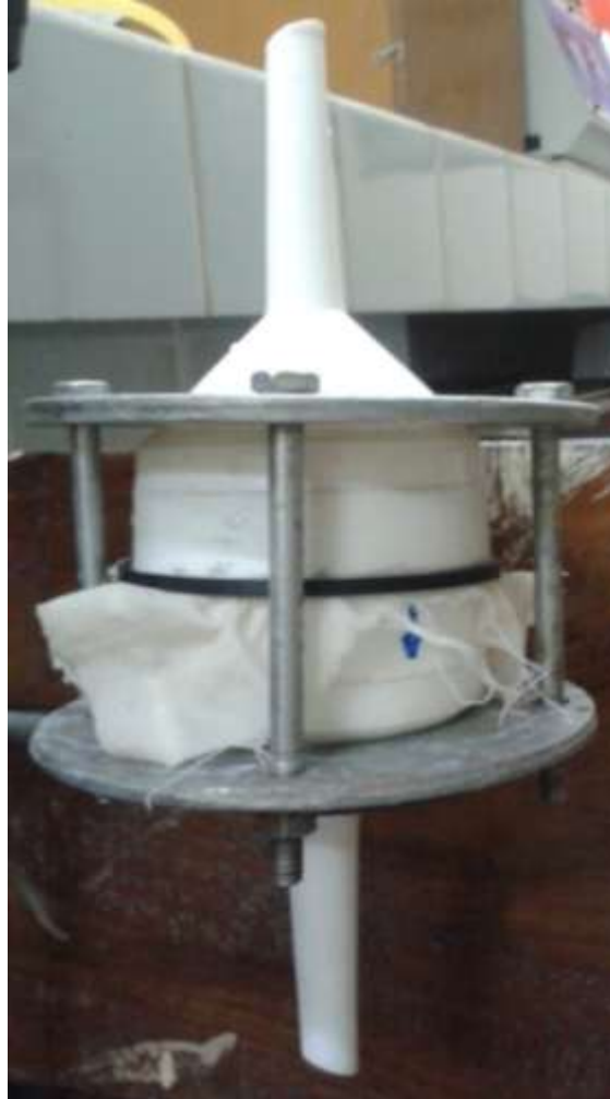
Figura 2 - Equipo de filtración escala Piloto.
