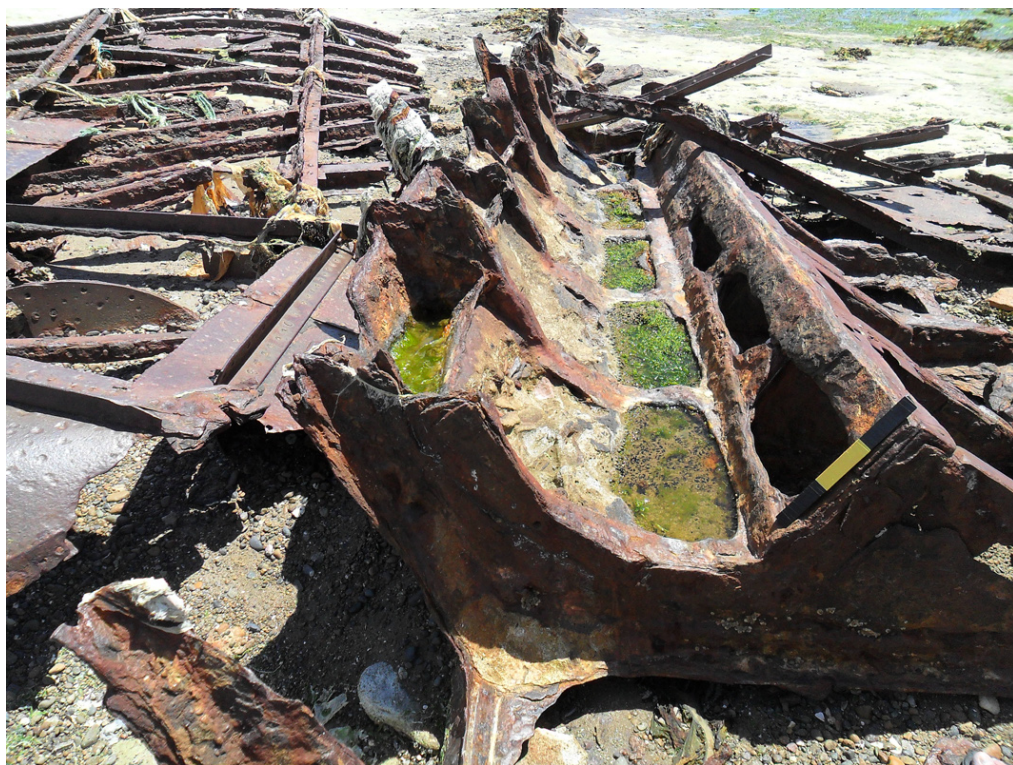
Figura 10. Cama de la bancada de la máquina, vista de proa hacia popa. Escala: 30 cm (Foto: J. Frère 2014).
