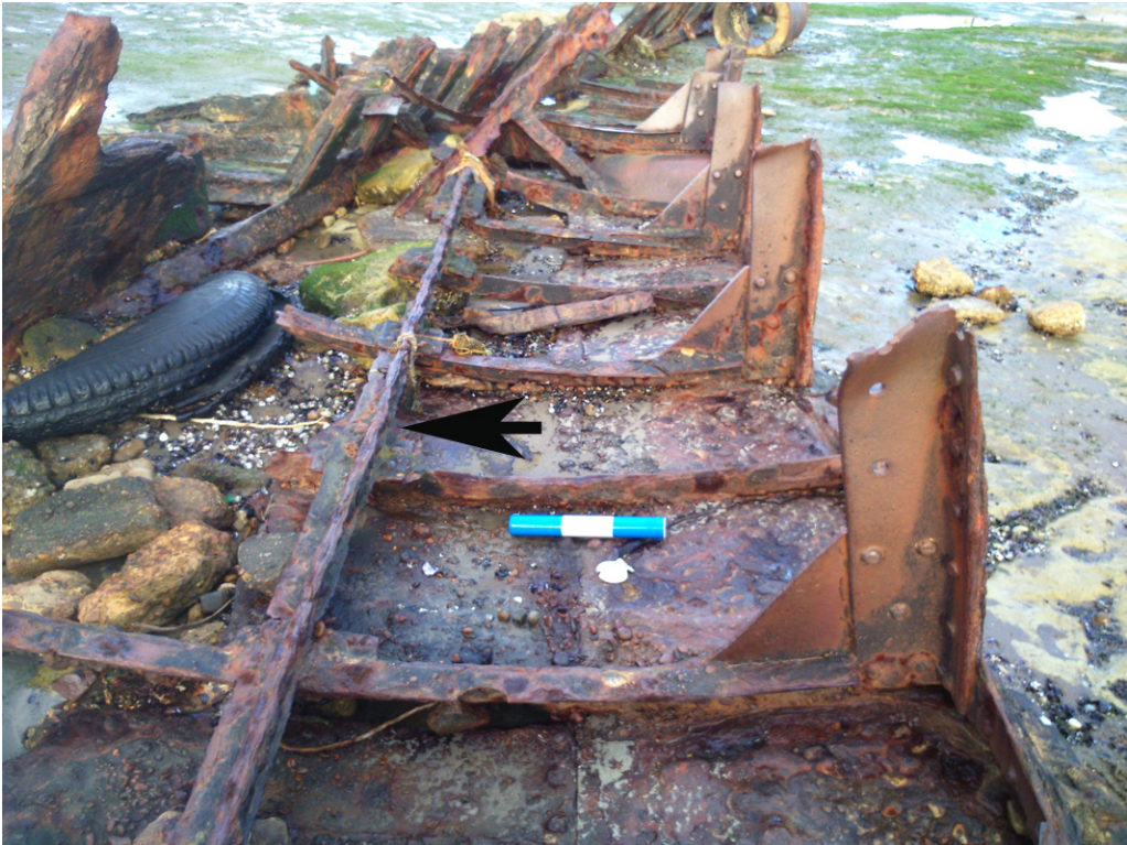
Figura 8. EN° 5, vista desde popa hacia proa. Se observa la vagra próxima a la cubierta. Perpendicularmente se aprecian las cuadernas remachadas al forro. Se distinguen las cuadernas simples y dobles, estas últimas unidas a curvas y baos. Escala: 30 cm (Foto: G. Gutiérrez 2017).
